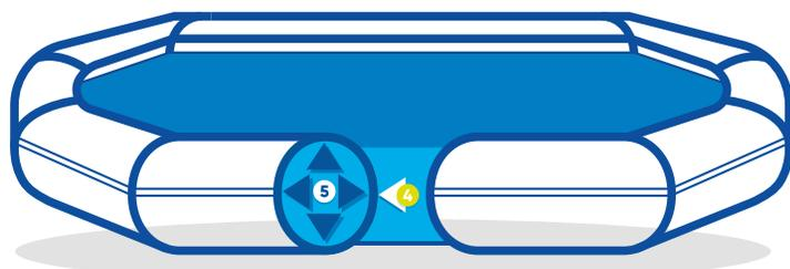
La structure rectangulaire du bassin équilibre naturellement les pressions : celle de l'eau du bassin ④ est équilibrée par celle de l'eau du boudin ⑤. C'est une garantie de fiabilité incomparable au moment de l'installation, comme au cours de l'utilisation.
