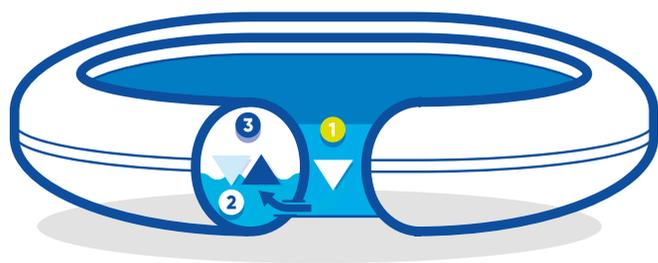
L'eau du bassin exerce une pression croissante ① avec la profondeur. L'eau circule du bassin au boudin par des orifices situés en bas du boudin ②. La pression de l'eau est alors appliquée à l'air emprisonné par le boudin ③. La tenue du bassin est ainsi garantie.
